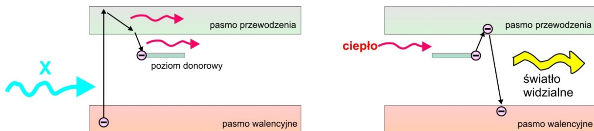
Rys. 5.6. Zasada działania detektorów TLD.
